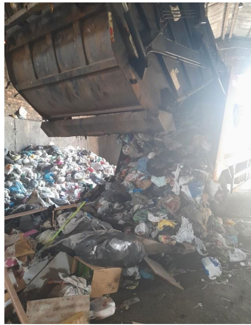
Figura 52: Procedimento para descarregar os resíduos da coleta regular de resíduos na área de transbordo.
