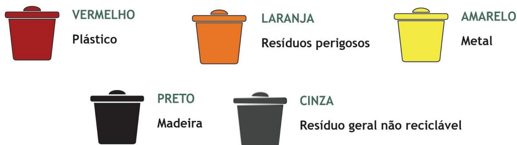
Figura 5: Cores dos contentores de resíduos CONAMA 275/2001.
