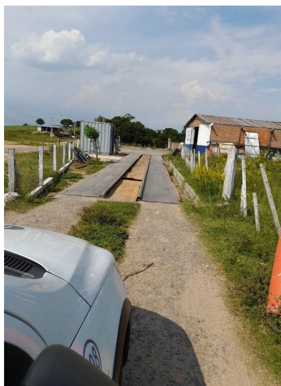
Figura 48: Balança de caminhão da estação de transbordo.
