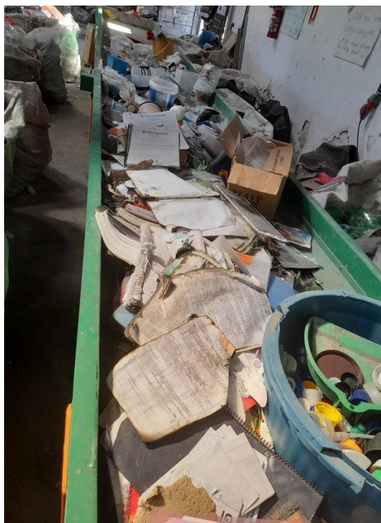
Figura 90: Esteira com material para triagem manual.
