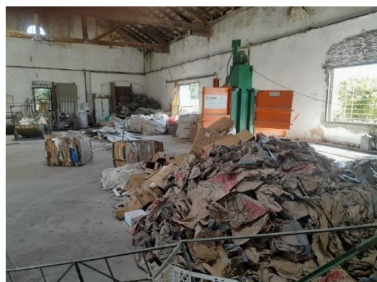
Figura 96: Sacos de cimento separados antes da compactação em fardos com a imagem da prensa ao fundo.
