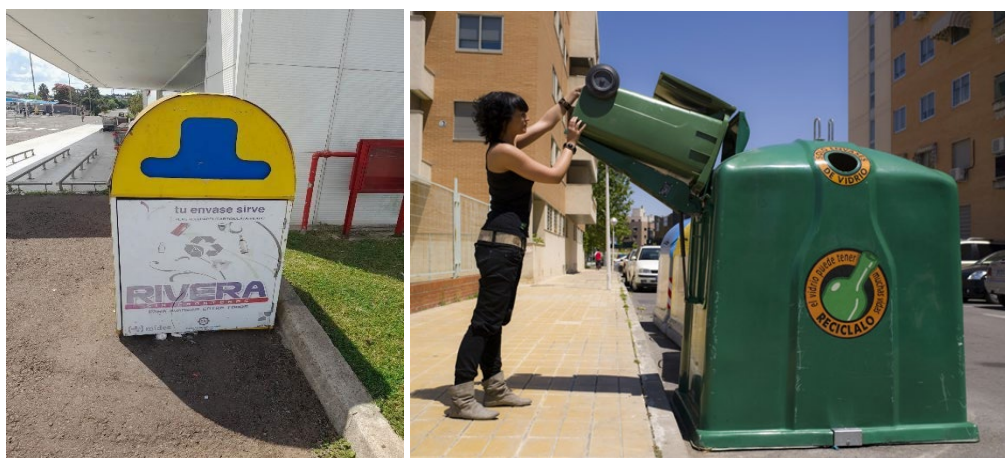
Figura 25: Exemplo de PEV em Rivera e modelo proposto de PEV; iglu de coleta de vidro com sistema VACRI para a deposição de resíduos a partir de contêineres por geradores não domésticos.
